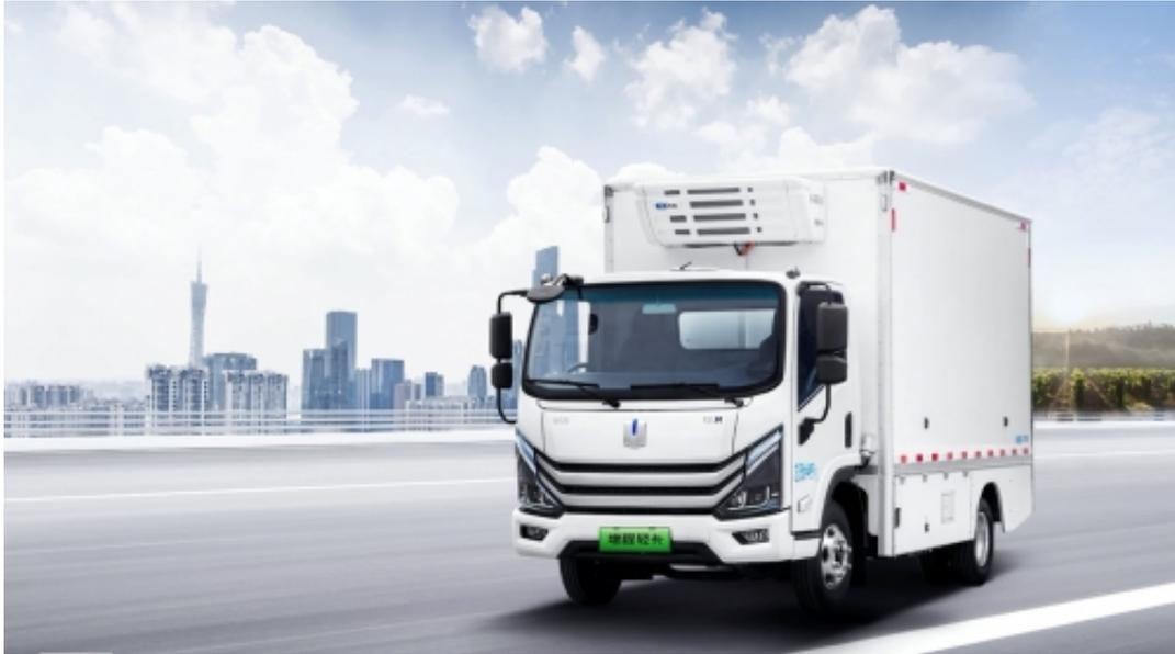
远程星智GLR搭载自研e-GAPF增程式技术，采用大电量电池，纯电续航120公里，并配有纯电开关，不依赖充电桩，里程无忧，每公里使用成本比柴油车省0.4元左右，节能环保，省钱省心。车辆还配备17-21m<sup>3</sup>超大容积货厢，满足各类货物及托盘装载，高效运输，一路畅通。
