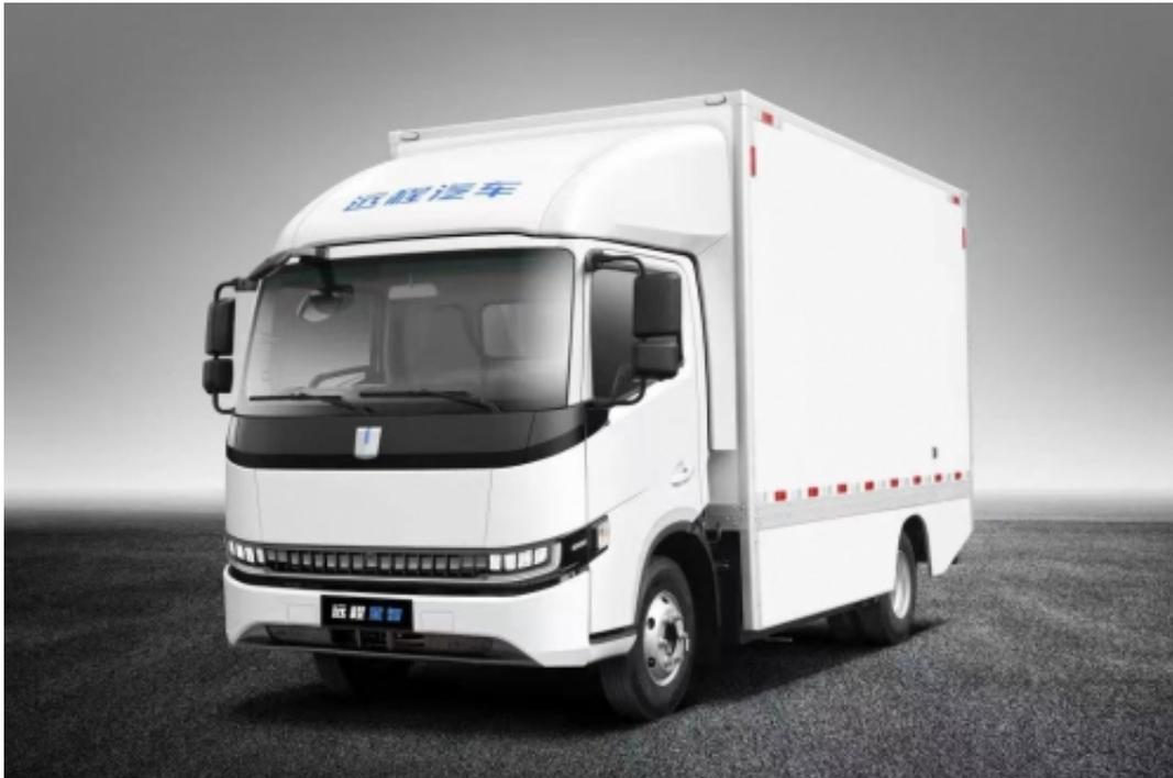
远程星智H是依托新能源轻卡专属智慧架构完全正向研发的首款智能轻卡。C-WTVC工况下续航 260公里，电量从20%充到100%不到1小时，完全满足城配用户的续航需求。同时整车大量采用高强度钢、复合材料，配备电驱动桥，使整车拥有极致的轻量化，同时实现超强承载。
