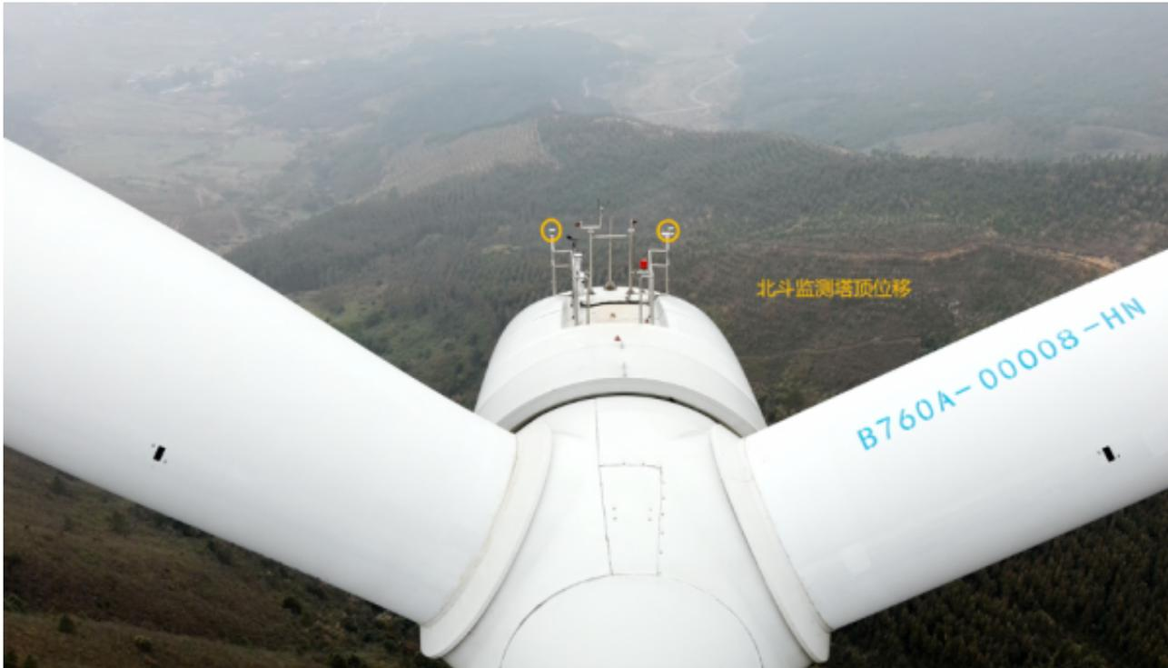
本项目依托北斗双天线位姿监测、单北斗监测以及无线智能感知技术取得的成果，深入分析风机结构及运行特点，结合在数据挖掘行业模型，构建了基于北斗卫星高精度便携定位技术的风机基础安全监测体系，实现了云-边-端一体化的实时感知风机塔顶的摆动轨迹、塔筒的倾斜状态、塔基的基础沉降情况等参数，实现在风电场升压站对所有的风机塔筒参数的汇集、分析和展示。
