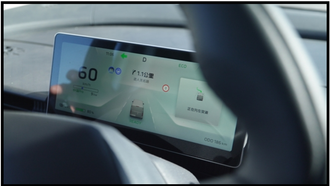
此外，智能速度辅助(ISA)通过识别路边标识获取限速信息，超速时及时向驾驶员发出提醒或者自动调节目标车速(需设置);智慧躲闪(SDA)功能则在集成式巡航辅助模式(ICA)功能开启时，当超越邻道大型车辆时，乐福会模拟老司机的超车行为，自动往稍微远离大车的一侧行驶，超车完成后恢复车道居中行驶，提升驾驶安全感。这些功能全方位保障了驾驶的安全与便捷，让用户在日常送货过程中更加安心、省心。
