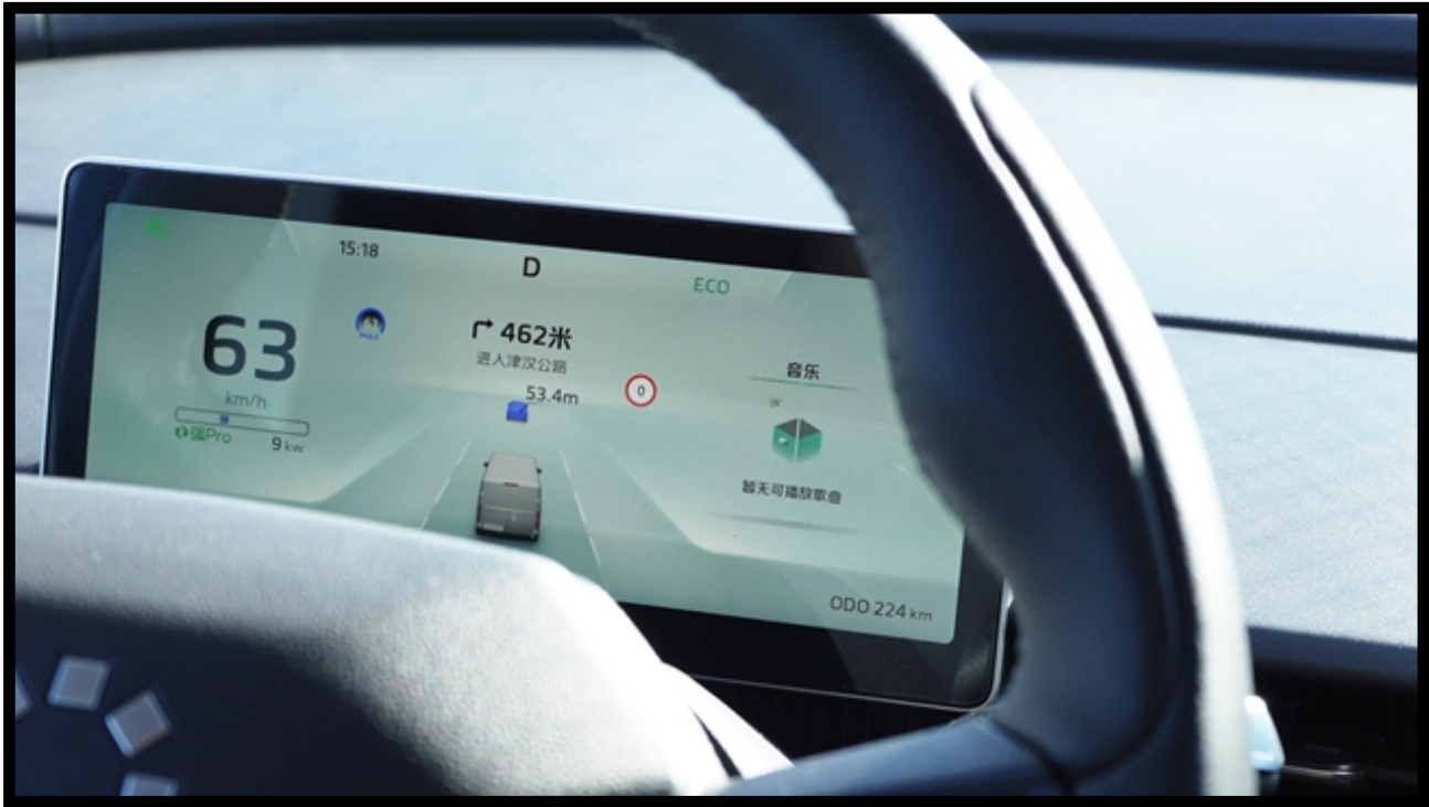
拨杆变道(DLCL)功能带来新奇又实用的体验。车速在45 km/h以上时，只需向要变道的方向推动转向杆，车辆将自动识别目标车道的车辆和障碍物，自动控制转向和车速，在确保变道安全的前提下完成变道，让驾驶操作更加便利，提高变道安全和效率。
