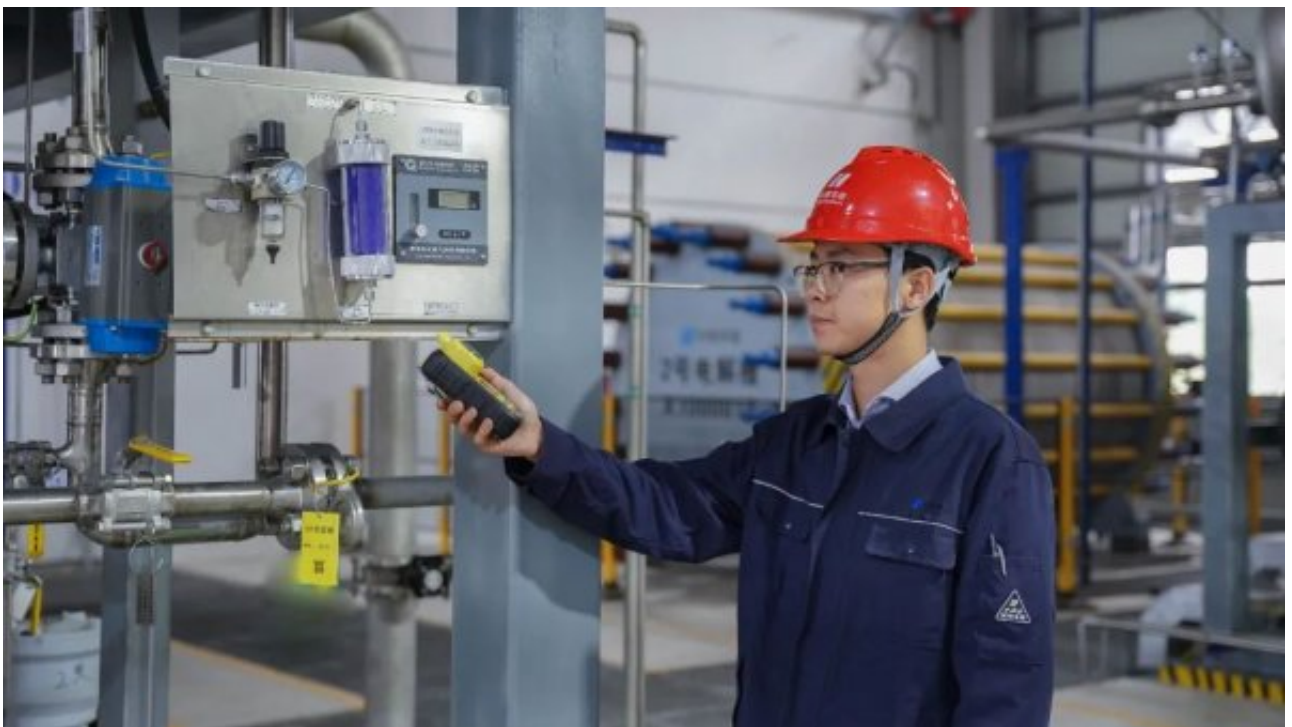
检测制氢装置氢气漏点
